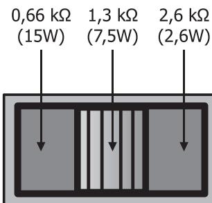
Входной импеданс (подводимая мощность) CS-610F/615F определяется положением движкового переключателя.
